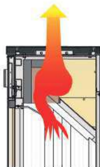
Principe de l'accumulation de la chaleur
